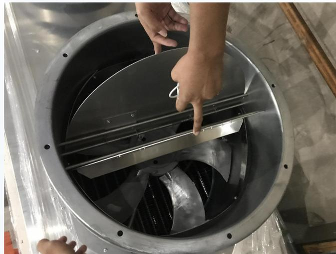
化霜时除霜织物风门覆盖在蒸发器风机表面，挡在蒸发器前面阻挡风机余转时带来的不必要气流，既可以阻挡化霜热气进入冷库内造成化霜温升，也可以阻挡冷库内冷气进入风机减缓化霜效果，延长化霜时间。
