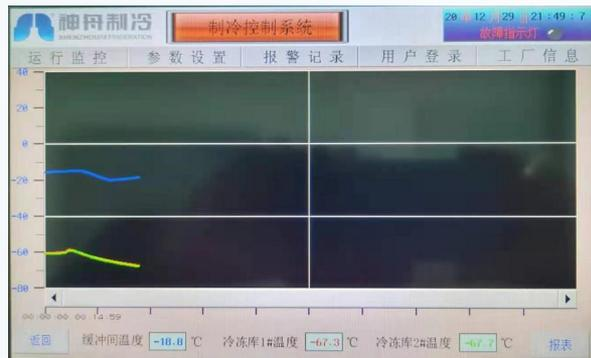
制冷系统采用西门子PLC控制方式，增加控制柜及远程监控系统实现本地与异地的双重控制；
